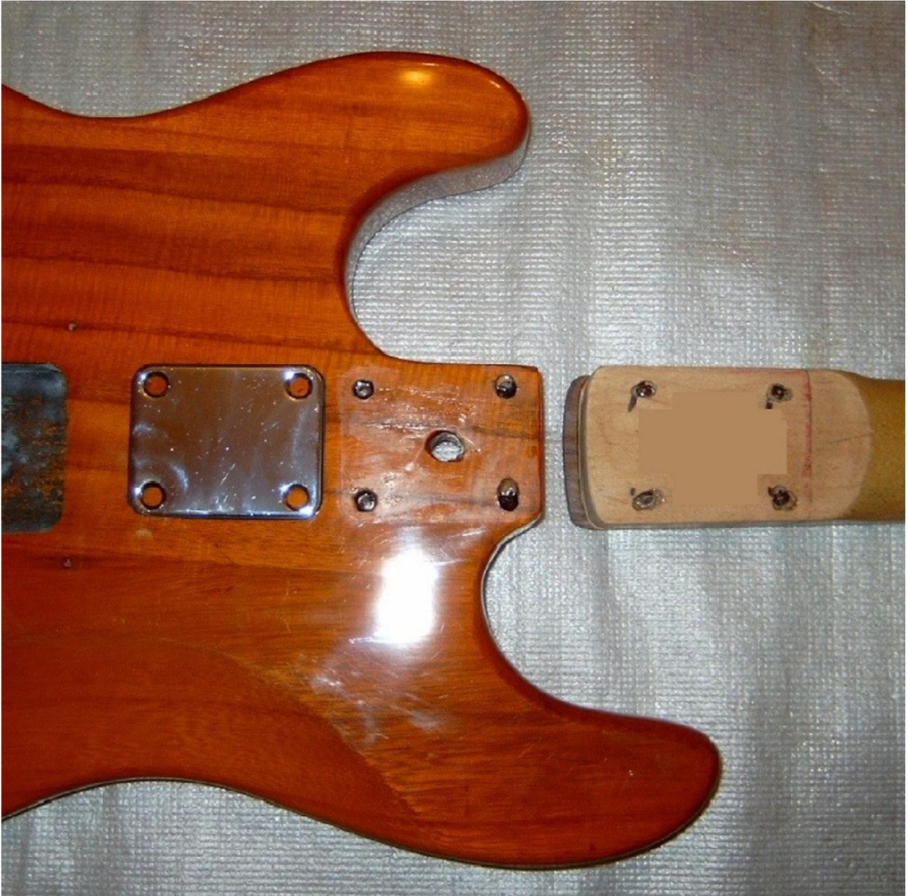
Body und HalsAnsatz von unten. Die im Bild nicht gut erkennbaren schwarzen Kreise, kennzeichnen den Sitz der neuen Bohrungen. Daran ist zu erkennen wie sehr die ursprünglichen Bohrungen stellenweise total daneben liegen – rechts unten.
