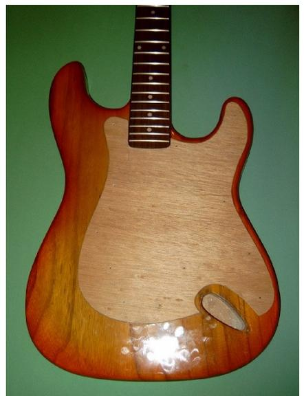
Das Pickguard ist gebohrt, die Löcher von oben versenkt und von beiden Seiten mehrfach mit Schleifgrund bestrichen.
