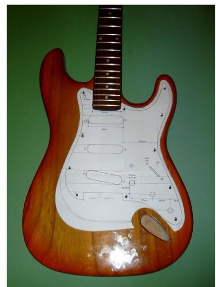
Hier ist das Original in seinen Umrissen gut zu erkennen. Die ursprünglichen Masse des Schlagschutzes habe rundum etwas verbreitert, weil mir die Bohrungen für die Schrauben zu dicht am Rand erschienen und ich den Rand vielleicht abschrägen werde. Unten kommt ein dicker Bauch hinzu, weil die neue Steg-Halterung genau über dem Loch der ursprünglichen Saiten-Halterung angebracht werden muss.
